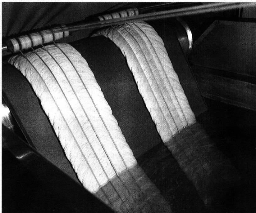
Das mit dem Chemset-Verfahren behandelte Garn verlässt das letzte Bad. Die gleichmässige Struktur ergibt ein hervorragendes Substrat für chemische Behandlungen.
