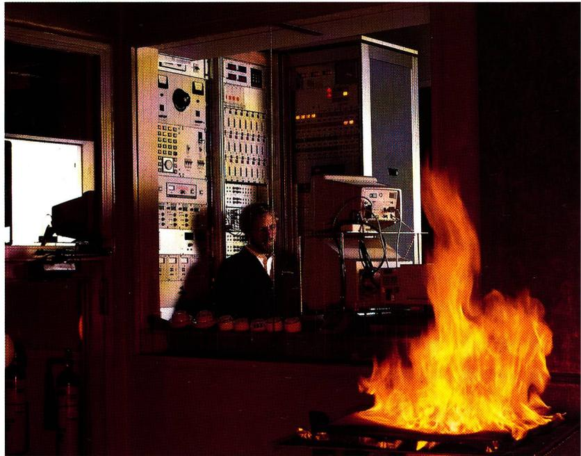
*Forschung und Entwicklung. Aufzeichnung, Speicherung und Auswertung von Brandphänomenen, hier insbesondere Infrarot-Strahlung und Temperatur-Abstrahlung der Flamme eines Polyurethanbrandes.*
