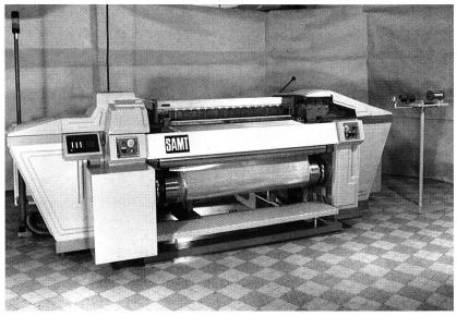
Besonders geeignet für Metallgewebe ist die neue Webmaschine MAV/TM der SAMT. Bild: SAMT, Mulhouse
