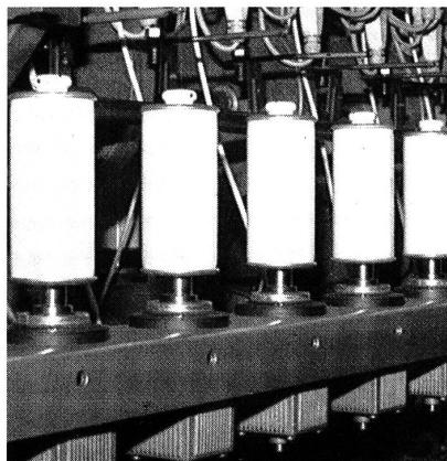
*Einzelmotorisch angetriebene Hohlspindeln können optimal den Prozessanforderungen angepasst werden. Sie bieten den Vorteil der Flexibilität. Maschinen können in der Anzahl der Positionen leichter den Erfordernissen wie Raumangebot oder Kapazität angepasst werden.*
