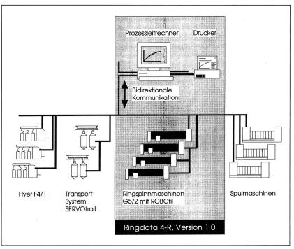
Die Realisierung von Ringdata 4-R beginnt bei den Ringspinnmaschinen G5/2 (Abb. 3)
