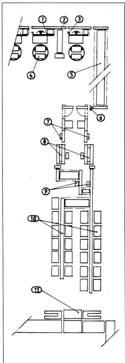
Die zwei Verpackungsmaschinen Typ Dynapak 500 A1 packen fortwährend 500 Stoffrollen pro Stunde, mit heller und dunkler Polyäthylenfolie, bei regulierbarer Stärke nach Kundenwünschen von 30 bis zu 200 micron.
