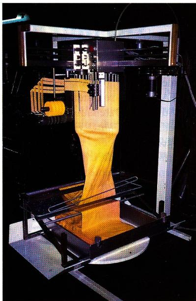
Die Schlauchware kann gerollt oder getafelt in die Maschine gegeben werden. Das Abrollen bzw. die Förderung des Stoffes ist vollautomatisch.
