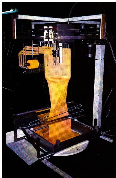
Die Schlauchware kann gerollt oder getafelt in die Maschine gegeben werden. Das Abrollen bzw. die Förderung des Stoffes ist vollautomatisch.
