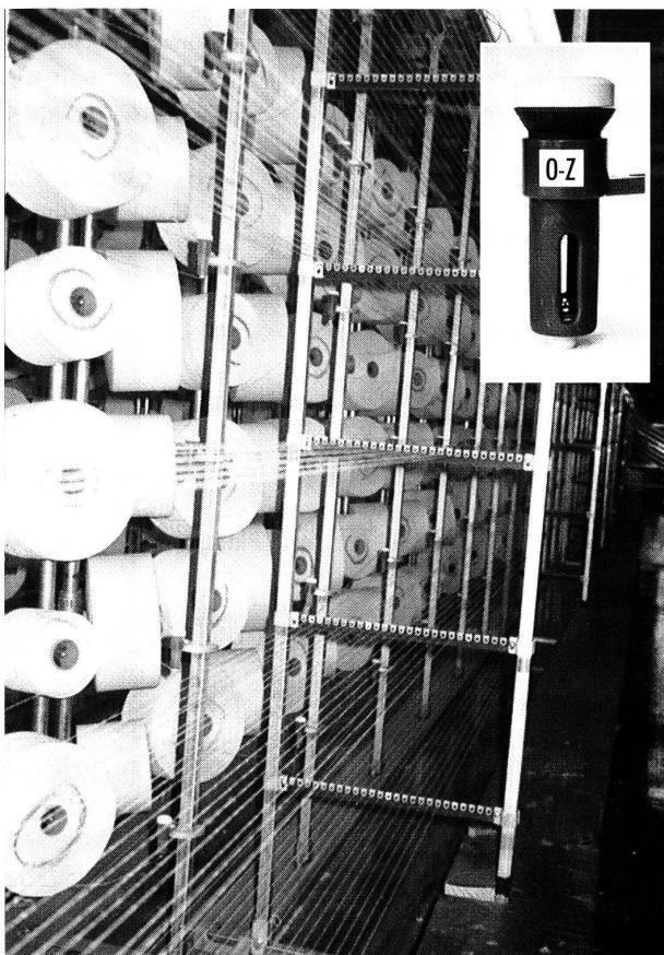
Sie benötigen an Ihrem Zettelgatter eine gleichmässige, präzise Garnführung und genau dafür hat O-Z® die richtige Lösung. Montieren Sie unsere Dämmung an Ihr Gatter. Resultat:
