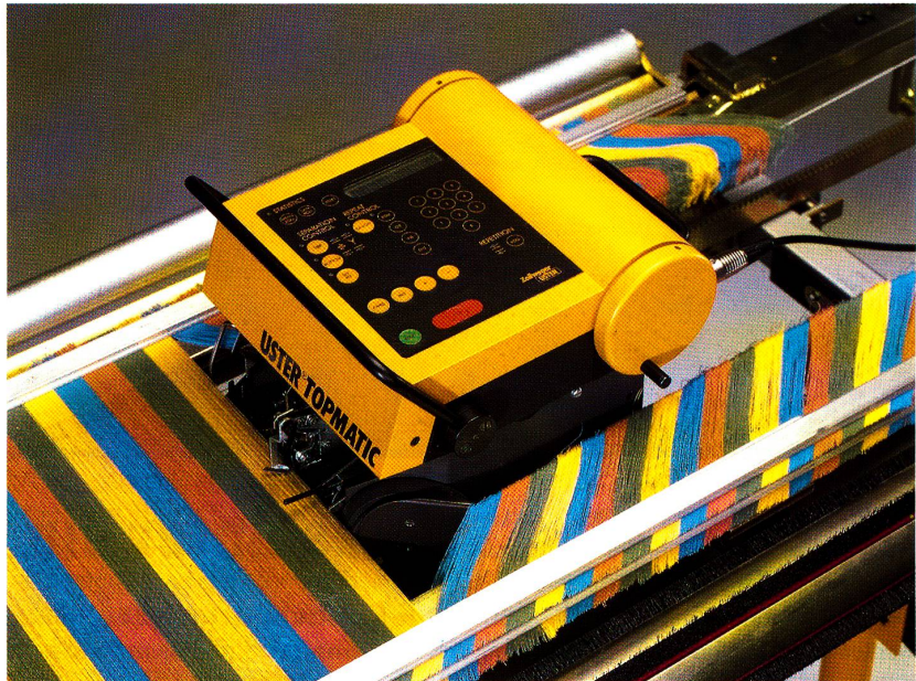
Die Uster Topmatic PC mit mikroprozessorgesteuerter Doppelfadenabstellung ohne Verwendung eines Fadenkreuzes.
