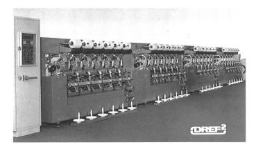
Diese Lunten werden auf vier DREF 2 24-Kopf-Maschinen zu Qualitätsgarnen versponnen, die für Jeans, Vorhänge, Tapeten, Möbelbezugsstoffe und Autoteppiche Verwendung finden. Zur Erweiterung der Produktpalette ist je eine der vier DREF 2-Maschinen mit Boucléeinrichtung bzw. PEO-Flammgarngerät ausgerüstet.
