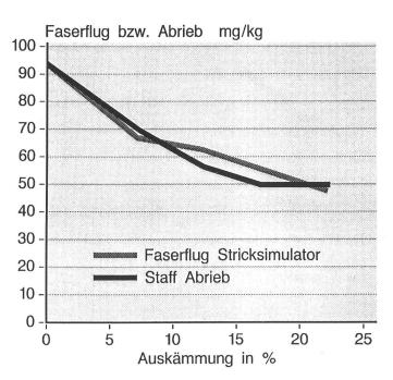
Bild 8: Reduktion des Faserflugs auf der Strickmaschine
