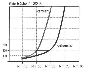
Bild 4: Verschiebung der Spinngrenze durch das Kämmen
