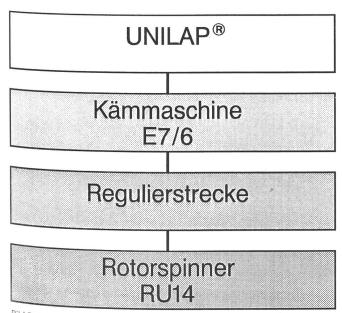
Bild 5: Spinnsystem für gekämmte Rotorgarne
