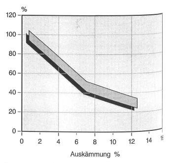
Bild 3: Reduktion des Schmutzgehaltes im Band durch Kämmen
