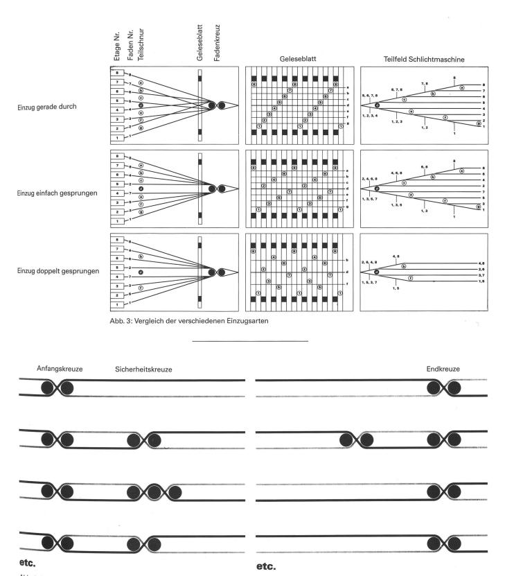
Abb. 4: Beispiele von Fadenkreuzfolgen. Bis 10 Kreuze sind pro Band frei programmierbar
