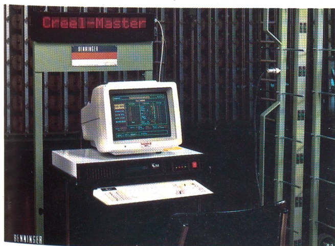
Commander-Einheit des Creel-Master-Systems mit einfacher menügeführter Bedienung
