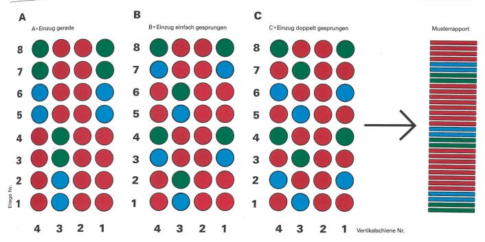
Aufstecken der Spulen bei gleichem Rapport, aber unterschiedlichen Einzugsarten
