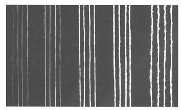
Verschiedene luftblastexturierte Garne mit unterschiedlicher Überlieferung
