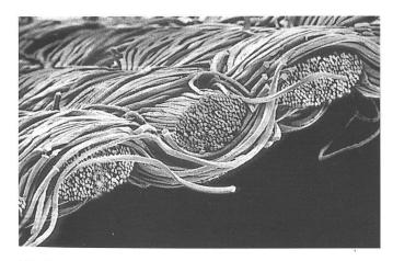
Mikrofilamentgewebe-Finesse Kette: dtex 100f 80 falschdrahttexturiert Schuss: dtex 167f 256 luftblastexturiert
