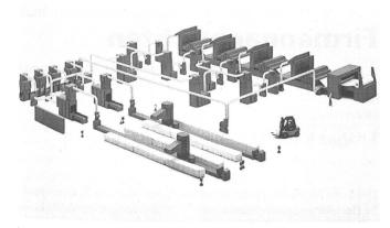
Vorbereitungsanlage für die Vliesherstellung Leistung bis zu 1600 kg/h Ballenöffnung automatisch
