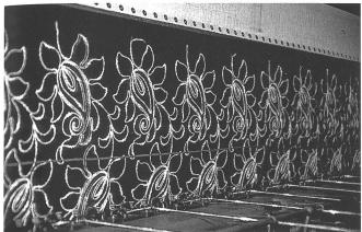
Vor allem für den Einsatz in der Damenoberbekleidungsindustrie sind die beiden Stickmaschinen mit Soutache-Einrichtung bestimmt, im Vordergrund sind die dazu verwendeten bauschigen Effektgarne erkennbar.
