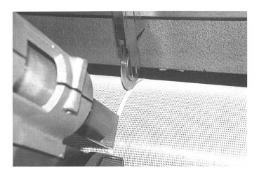
Gegenüber dem direkten Schnitt ergeben sich unter anderem Vorteile durch eine höhere Produktionsgeschwindigkeit und eine variabel von ein bis zehn Milimeter einstellbare Breite der Schweisskante sowie eine Profilierung der Kante.
