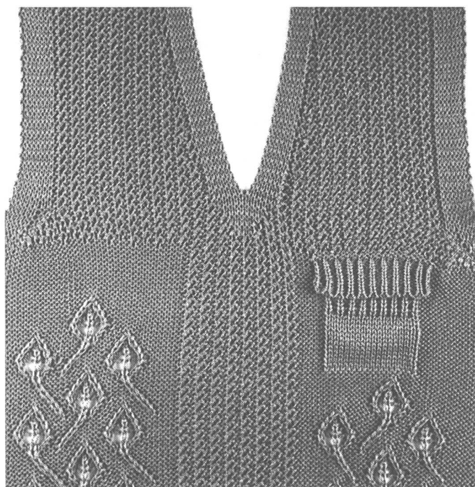
Abb. 7: Formgestricktes Strukturvorderteil mit Flapptasche 1:1. Tasche und Taschenklappe werden im variablen Hub gleich mit angestrickt. Wesentliche Einsparungen an Garnmaterial, Lauf- und Konfektionszeiten.
