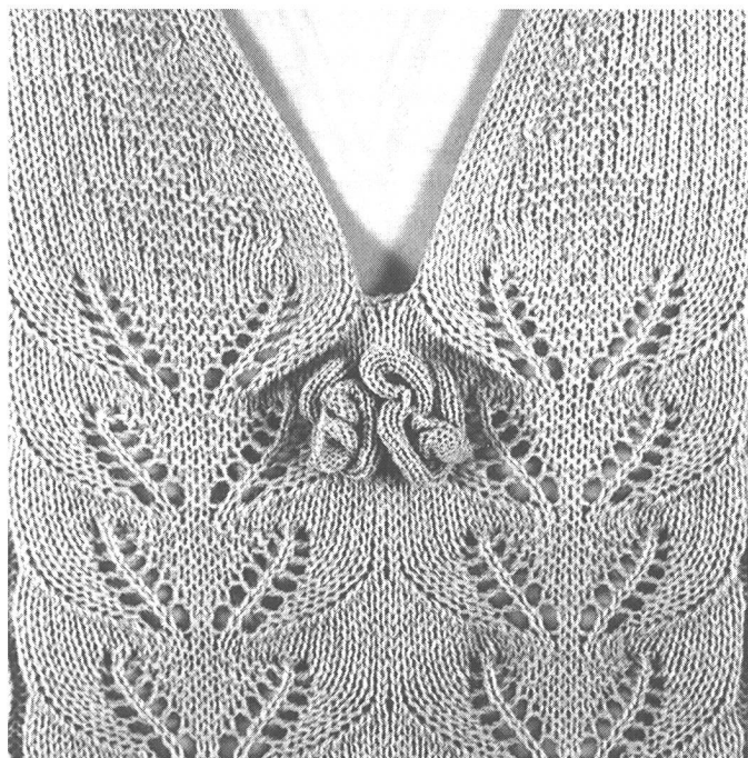
Abb. 1: Orchideen-Applikation, wie sie die CMS direkt anstrickt. Der Schlitten läuft dabei nur über die Nadeln, die arbeiten.
