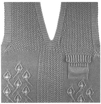
Abb. 7: Formgestricktes Strukturvorderteil mit Flapptasche 1:1. Tasche und Taschenklappe werden im variablen Hub gleich mit angestrickt. Wesentliche Einsparungen an Garnmaterial, Lauf- und Konfektionszeiten.
