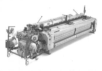
Abb. 15: P 7100 B 390 N 4 SP R D1 Sulzer-Rüti-Vierfarben-Projektilwebmaschine mit einer Nennbreite von 390 cm, belegt mit einem Dekostoff, ausgerüstet mit Schaftmaschine, elektronisch gesteuertem Kettablass und automatischer Schussuch- und Fachhebevorrichtung.
