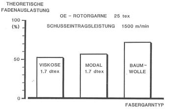
Abb. 7: Luftdüsenwebmaschine. Materialabhängige Fadenauslastung beim Bremsvorgang
