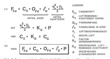
Abb. 2: Fadenantriebskraft beim Luftdüseneintrag (Hauptdüse)
