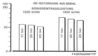
Abb. 9: Luftdüsenwebmaschine. Feinheitsabhängige Fadenauslastung beim Bremsvorgang
