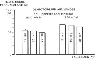
Abb. 8: Luftdüsenwebmaschine. Feinheitsabhängige Fadenauslastung beim Bremsvorgang
