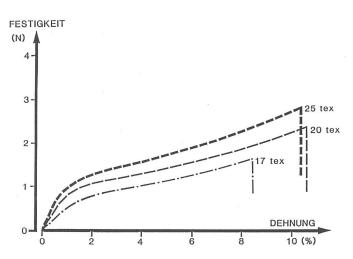
Abb. 10: Kraft-Dehnungskurven (Mittelwerte) OE-Rotorgarn aus Viskosefasern
