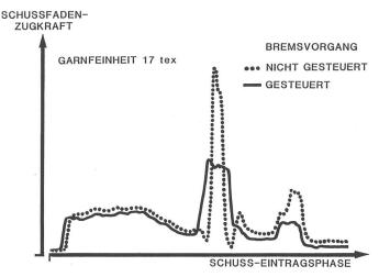
Abb. 14: Schussfaden-Zugkraftverlauf. OE-Rotorgarn aus Modalfasern
