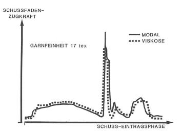
Abb. 12: Schussfaden-Zugkraftverlauf. Vergleich von OE-Rotorgarnen aus Viskose- und Modalfasern
