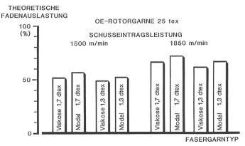
Abb. 6: Luftdüsenwebmaschine. Theoretische Fadenauslastung beim Bremsvorgang
