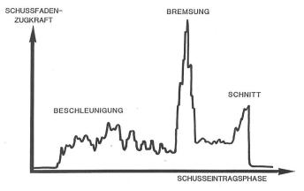
Abb. 5: Luftdüsenwebmaschine. Schussfaden-Zugkraftverlauf
