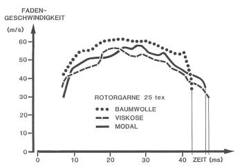
Abb. 3: Verlauf der Schussfadengeschwindigkeit
