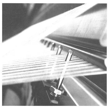
Abb. 1: Luftdüsenwebmaschine. Blick ins Webfach
