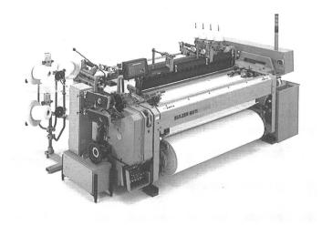
Abb. 17: L 5100 S 190 N 2 IK TE Sulzer-Rüti-Zweifarben-Luftdüsenwebmaschine mit Innentritt mit einer Nennbreite von 190 cm, belegt mit einem Schürzenstoff, ausgerüstet mit elektronisch gesteuertem Trommelspeicher, automatischer Schussfehlerbehebung und elektronisch gesteuertem Kettablass.
