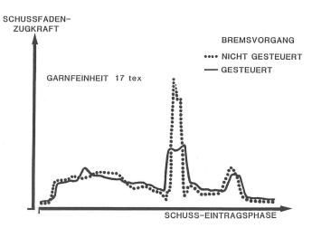
Abb. 13: Schussfaden-Zugkraftverlauf. OE-Rotorgarn aus Viskosefasern
