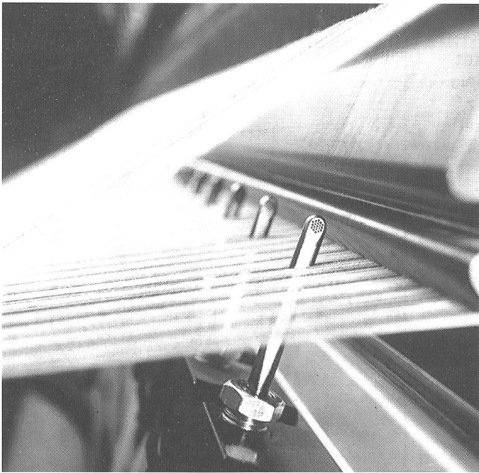
Abb. 1: Luftdüsenwebmaschine. Blick ins Webfach
