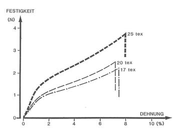
Abb. 11: Kraft-Dehnungskurven (Mittelwerte) OE-Rotorgarn aus Modalfasern
