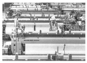
Webmaschinenanlage der Handan Cotton Mill mit 50 Sulzer Rüti Projektilwebmaschinen, auf denen das Unternehmen mehrbahnig hochwertigen Popeline herstellt. Das vollstufige Unternehmen beschäftigt 8000 Mitarbeiter und gehört mit 100 000 Spindeln und 2600 Webmaschinen zu den grössten Textilunternehmen in China. Das Produkteprogramm reicht vom leichten und mittelschweren Baumwollköper bis zum feinen Popeline und Inlett. Mehr als 90 % der Gewebe werden exportiert.
