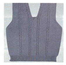
Abb. 9: Formgebung über Fully-Fashioned-Technik (MC-745)
