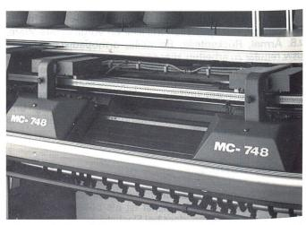
Abb. 5: Doppelkopf-Anordnung der Schlitten beim Typ Universal MC-748
