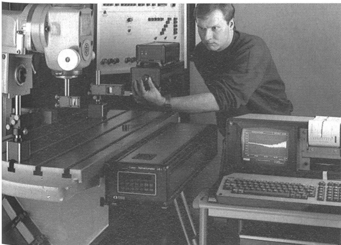
Dynamisches Messen mit dem Laserinterferometer ZLI 15 von Spindler & Hoyer. Bild: Leica AG
