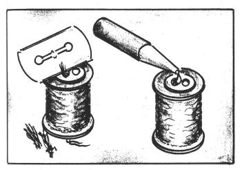
Abschneiden des überstehenden Probematerials und Einbettung mit Sekundenkleber
