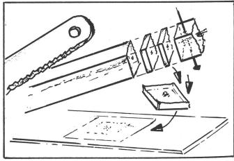
Einguss mit der Eisensäge in 1,5 bis 2 mm Scheiben zerlegen und zum Dünnschliff-Präparat verarbeiten
