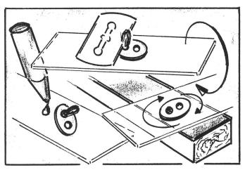
Aufkleben des einseitig geschliffenen knopfes mitten auf Objektträger und nass dünnschleifen bis zu gewünschten Mikrondicke
