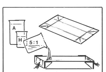
Gefalztes Alu-Blech und daraus gefaltetes Giesswännchen mit eingefügter Faden-Probe. Eingiessen mit der Araldit-Härtermischung 5:1
