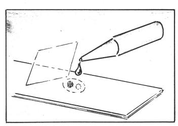
Fertigstellung des Dünnschliffpräparates durch Aufkleben eines Deckglases mit einem Tropfen Schnellkleber
