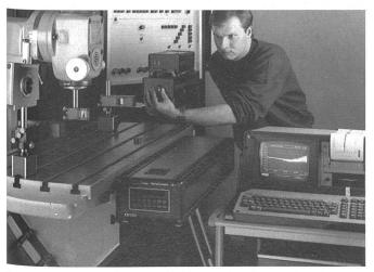
Dynamisches Messen mit dem Laserinterferometer ZLI 15 von Spindler & Hoyer. Bild: Leica AG
