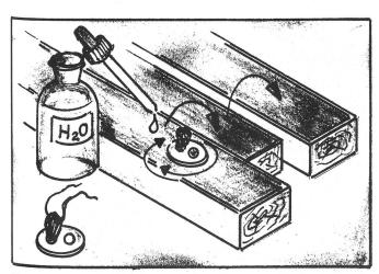
Planschleifen des Kragenknopfes mit der Probe mit Nassschleifpapier verschiedener Körnung
