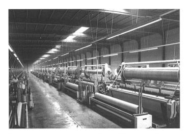
Webmaschinenanlage Lystex der Beaulieu-Management-Gruppe in Comines, Belgien, mit 126 Sulzer Rüti Projektilwebmaschinen des Typs P 7100, auf denen qualitativ hochwertige Polypropylen-Teppichgrundgewebe hergestellt werden.
