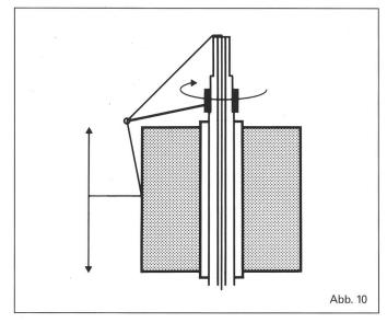
Aufwärtsbewegung des Ablaufpunktes (Bild 10). Der Zwirnflügel wird also im Wechselspiel ständig beschleunigt und wieder gebremst. Die Beschleunigung der Zwirnflügel-Masse bewirkt damit Fadenzugkraftschwankungen im Garn.
