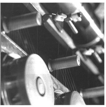
Korrosions- und Verschleissfestigkeit sowie geringe Rauhtiefe der Oberfläche, Leichtgängigkeit und hohe Steifigkeit sind wesentliche Kriterien bei Verlegerollen.
