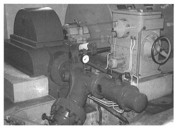
Brumbach-Werk, Pelton Turbine vorn und Generator im Hintergrund; die Leistung beträgt 1700 kWh
