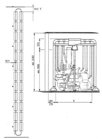
Im Normalfall wird die Laufbahn auf spezielle Stützen gesetzt, wobei es uns bisher immer gelungen ist, diese so zwischen den Maschinen zu plazieren, dass sie nicht störend wirken. Eine Aufhängung der Laufschienen an der Saaldecke ist möglich, wenn es die Statik zulässt. In diesem Fall muss allerdings mit erhöhten Investitionskosten gerechnet werden.
