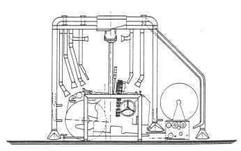
Für Projektil-Webmaschinen können wir am Gerät ein spezielles Hochdruckgebläse anbringen, das für eine gezielte und intensive Schusswerksreinigung sorgt.
