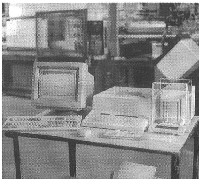
Das neue Mettler DSC12E ist ein kompaktes, leicht bedienbares Thermoanalysen-Instrument mit eingebauter Messzelle.
