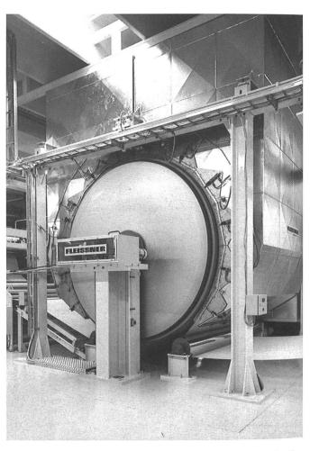
Durch Berücksichtigung aller strömungstechnischen Gesetze in Kanälen und Haube wird eine höchstmögliche Temperaturgenauigkeit über die Arbeitsbreite und über den Trommelumfang erreicht. Bild: Fleissner
