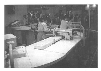
Quick Response System TSS von Toyota: bis zu fünf Maschinen pro Mitarbeiter. Quelle: APS Zürich
