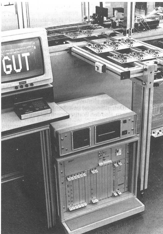
Das Bildverarbeitungssystem Vipro 5 integriert in eine Bestückungsanlage für Farbfernsehgeräte-Baugruppen. Die Module werden auf vollständige Bestückung überprüft. Bild: «ascom»
