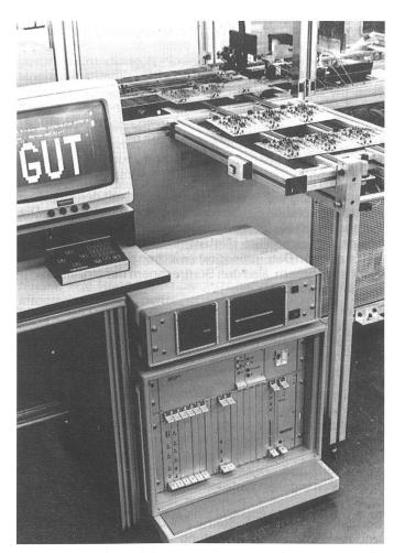
Das Bildverarbeitungssystem Vipro 5 integriert in eine Bestückungsanlage für Farbfernsehgeräte-Baugruppen. Die Module werden auf vollständige Bestückung überprüft.
