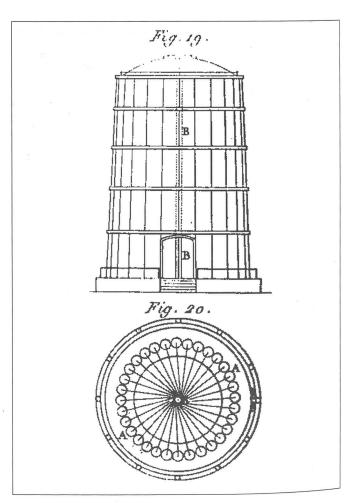
Bild 5 Im Patent von Stone und Henderson wurde vorgeschlagen, in einem Bauwerk von zwölf Metern Durchmesser und fünfzehn Metern Höhe 160 Nähmaschinen zu installieren, die zentral von der Mitte aus angetrieben werden sollten. In fünf Stockwerken könnten zehn Arbeiter das Nähen von Militärkleidung erledigen, für die sonst 100 Arbeiter nötig wären. Dies war jedenfalls die Meinung des englischen Erfinders.
