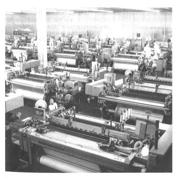
Webmaschinenanlage Spenge der Firma C.A. Delius & Söhne, Bielefeld, Bundesrepublik Deutschland, mit 190 Sulzer-Rüti-Luftdüsenwebmaschinen des Typs L5100, auf denen das Unternehmen mehrheitlich hochwertige Futterstoffe und Gewebe für den Oberbekleidungssektor produziert.
