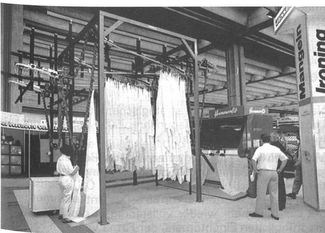
Auch im Wäschereibereich wird und muss dauernd automatisiert und rationalisiert werden. Über ein Rollensystem gelangen die zu bügelnden Wäschestücke zur Faltmaschine. Bild: mittex
