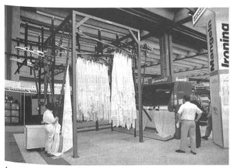
Auch im Wäschereibereich wird und muss dauernd automatisiert und rationalisiert werden. Über ein Rollensystem gelangen die zu bügelnden Wäschestücke zur Faltmaschine.
