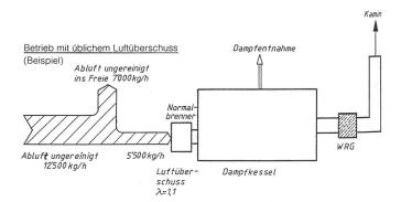
Abb. 1) Betrieb mit üblichem Luftüberschuss
