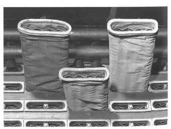
Nach drei Jahren im Einsatz zeigen die Nadelfilze noch keine Abweich<sup>ung</sup> im Filtrationsvermögen. Die Temperaturbeständigkeit liegt bei 260° <sup>C</sup>. Bild: Lenzing AG
