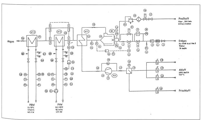
Aufgrund der erörterten Gegebenheiten entschied sich die Firma Lofa AG, eine thermische Nachverbrennung mit einer dreistufigen Wärmerückgewinnung zu installieren, wobei dem wirtschaftlichen Aspekt grosse Bedeutung zugemessen wurde.
