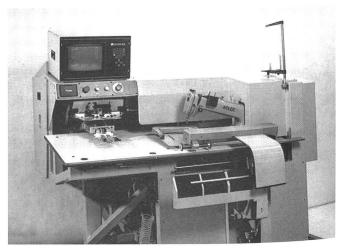
Nähroboter japanischer Bauart zum Einnähen von Ärmeln zeigen den Fortschritt in der Nähtechnik auf.
