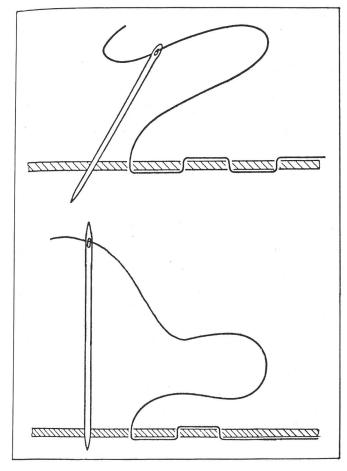
Bei der normalen Sticknadel, wie oben gezeichnet, muss die Nadel jeweils um 180 Grad gedreht werden, um von der Unterseite einzustechen. Die zweispitzige «Weisenthalsche Nadel» brachte hier den Vorteil, dass diese Drehung vermieden wurde, musste dafür allerdings in der Mitte mit den Fingern gehalten werden.
