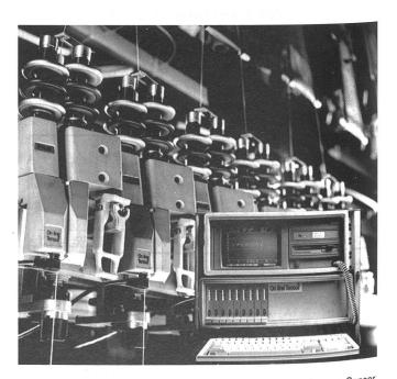
Das Fadenzugkraft-Messsystem «On-line Tensor» besteht aus Sensor, Auswerteelektronik, Rechnersystem, Software. Bild. FAG Kugelfischer
