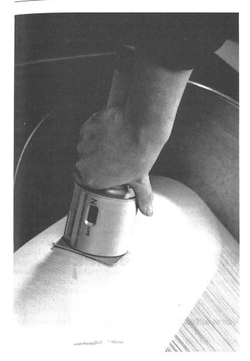
Wickelhärte-Messgerät Durometer III
