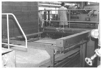
Bei Matratzeneinlagen erfolgt, EDV-gesteuert, automatisch eine Mittelzonenverstärkung.
