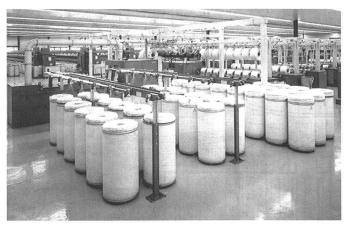
Gekämmt werden die OE-Garne in der neuen Spinnerei auf Rieter E7/6-Maschinen. Bild: Filinter SA
