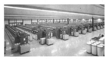
12 OE-Rotorspinnmaschinen Spincomat produzieren 2°-Konen mit konstanter Garnlänge auf allen 216 Spinnstellen. Jede Maschine ist mit einem Doffomaten ausgerüstet, drei Maschinen arbeiten mit zwei Wanderautomaten.
