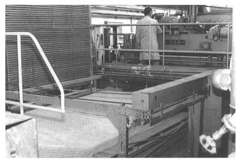
Bei Matratzeneinlagen erfolgt, EDV-gesteuert, automatisch eine Mittelzonenverstärkung.
