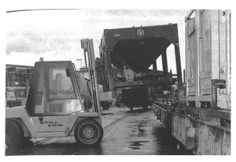
Der R70-80 von Still, ein Dieselgabelstapler, in dem überall dort, wo es zweckmässig und sinnvoll ist, die verschleissfreie Elektronik die Mechanik ersetzt, um konsequent die Forderungen nach Bedienungsfreundlichkeit, Sicherheit, Bequemlichkeit und Wirtschaftlichkeit zu erfüllen.
