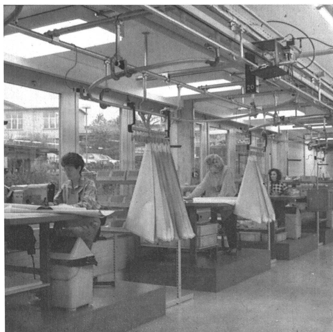
Zielgesteuerte Arbeitsplatz-Beschickung mit Hängebahn.
