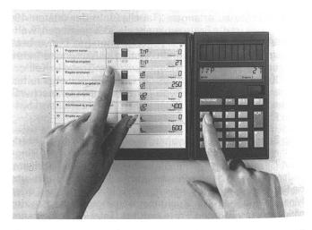
«Beltman» HC-1, eine Weltneuheit der Habasit AG in Reinach/BL, löst ab sofort alle Berechnungsprobleme bei Habasit-Antriebs- und Transport- elementen. Der Computer im Taschenformat führt im Dialog Schritt für Schritt zur richtigen Lösung – einfach und innerhalb von Minuten, «Beltman» HC-1 ersetzt die eher komplexen Ablese-Nomogramme, die bislang zur Berechnung dienten. Bild: Habasit
