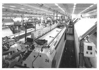
Tessival S.p.A. Blick in die neue Webmaschinenanlage der tessitura di fiorano S.p.A. in Fiorano al Serio, Italien, mit 156 Sulzer Rüti-Projektilwebmaschinen des Typs P 7100.
