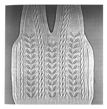
Abb. 1: Gemustertes Formstrickteil von der CMS 402 selectanit Tandemmaschine.
