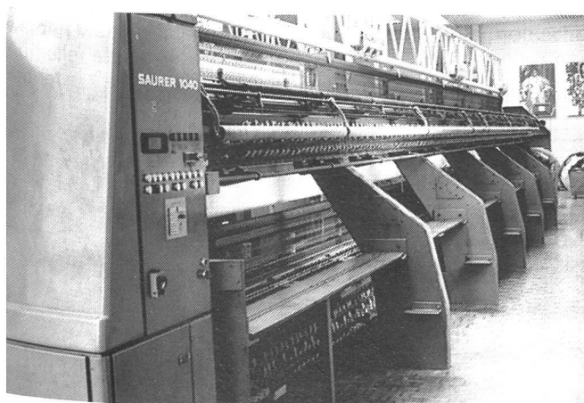
An den Saurer-1040-Einheiten wird das Maschinenterminal in den Schaltschrank integriert.
