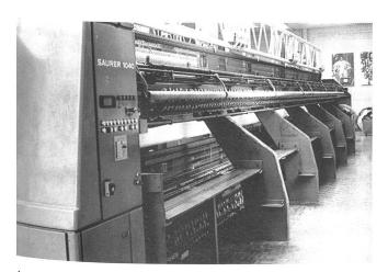
An den Saurer-1040-Einheiten wird das Maschinenterminal in den Schalt-<sup>schrank</sup> integriert.
