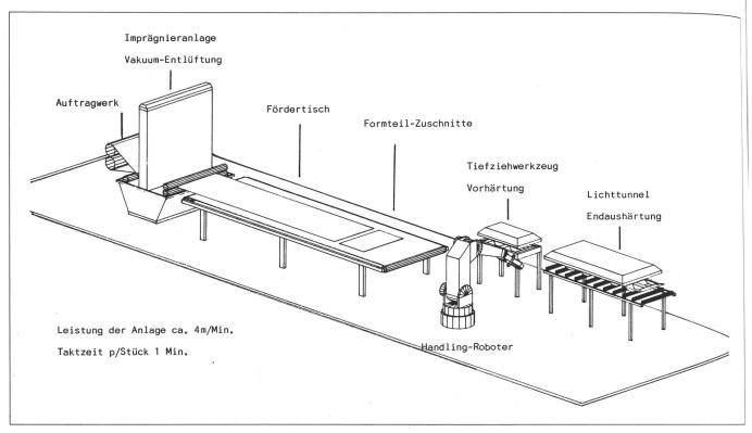
Industrielle Fertigung multiaxial verstärkter FVW-Bauteile.
