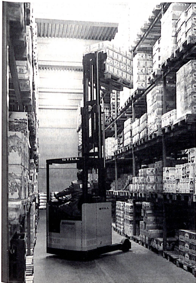
Unter der Typenbezeichnung EFSM stellt Still seine modifizierte Schubmaststapler-Reihe vor. Mit dem entsprechenden Freisicht-Triplexmast – nutzbare Hubhöhe max. 8570 mm – lassen sich praktisch alle vorkommenden Lageraufgaben effektiv und wirtschaftlich lösen. Foto: Still GmbH
