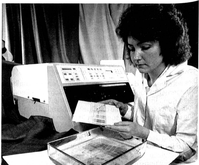
Im Bilde: In einem in Leeds befindlichen Labor der BTTG macht eine Technikerin von einer DNA-«Fingerabdruck»-Technik Gebrauch, um die in einer Stoffprobe enthaltenen Tierfasern zu bestimmen. Dieses Verfahren bildet einen wichtigen Vorstoss für die Organisation, die als erste davon im Zusammenhang mit Textilien Gebrauch gemacht hat. Es versetzt sie in die Lage, Fragen wie: «Besteht dieses Kleidungsstück wirklich aus reinem Kaschmir?» zu beantworten. Die Gruppe ist seit mehreren Jahren führend, was die praktische Verwertung der Molekularbiologie und der Biolumineszenz betrifft. Diese Verfahren sind für die Untersuchung der Auswirkungen von Schimmel und Bakterien auf Gewebe sehr nützlich.
